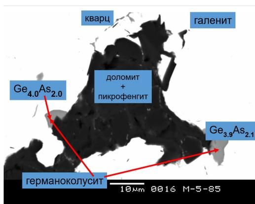
Рис. 14. Цумеб. Эпитермальное минерализация. При-контактные теннантит-галенитовые руды в доломитах. В галените включения германоколусита. Приведен состав двух кристаллов германоколусита. В отраженных электронах.
