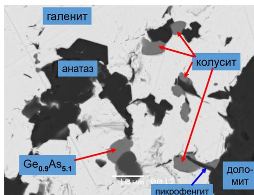
Рис. 7. Цумеб. Эпитермальная минерализация. Приконтактные галенитовые руды. В гнездах галенита включения анатаза, германийсодержащего колусита, пикрофенгита. Приведен состав одного из кристаллов колусита. В отраженных электронах.
