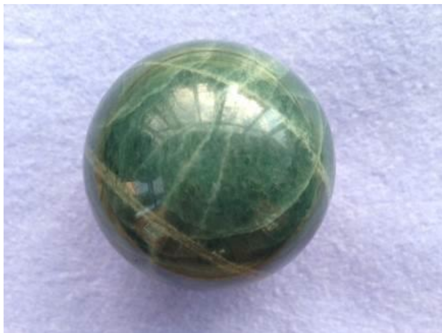
Рисунок 2.7.1.2 – Полированный шар из жадеита Беденского массива, отчетливо видна система трещин, которая значительно снижает качество поделочного сырья
