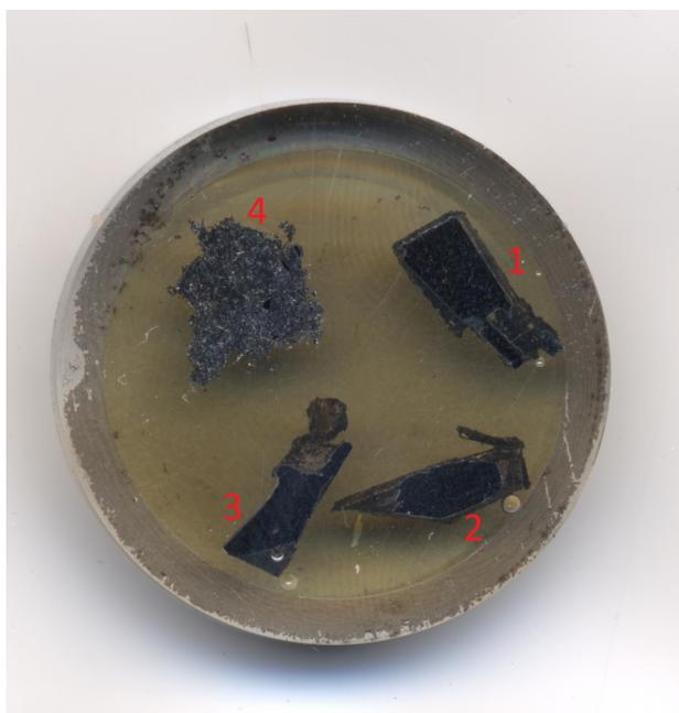
Рис. 2. Шашка FN-869 (фрагмент изученного образца обозначен цифрой 3). Внешний диаметр шашки 25 мм.
