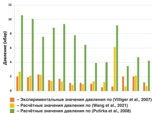
Рис. 5. Сравнительный анализ экспериментальных данных давления кристаллизации клинопироксена по (Villiger et al., 2007) и расчетных – по (Putirka et al., 2008; Wang et al., 2021).
