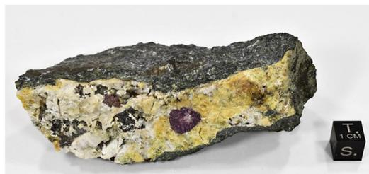
Рис. 4. Образец FMM\_1\_97131 с розеткой одихинчаита малинового цвета в агрегате канкринита, микроклина и альбита. Масштабный кубик имеет ребро 1 см.
