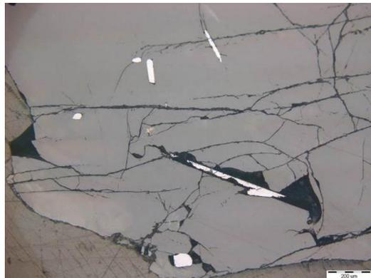
**Рис. 7.** Включения ботуобинскита (белое) в ксенокристе Si-содержащего пиропса из кимберлитовой трубки Интернациональная, Сибирская платформа. Линейка 200 мкм. Фотография в отраженном свете.
