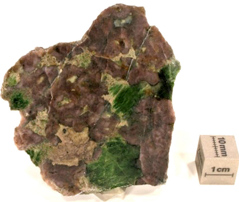
Рис. 2. Гигантозернистый эклогит. Состоит из травяно-зеленых частично измененных зерен Sr-омфациита (до 4 см), розового Ca-альмандин-пироба и рутила. Размер образца 7 \times 6 \times 0,8 см. Тироль, Австрия. FMM_1_3222. Фото Е.В. Кронрод.
