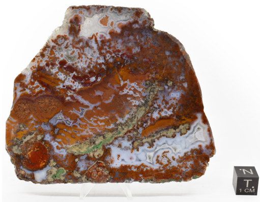
Рис. 16. Агат моховой со сложным «ковровым» рисунком, обусловленным включениями оксидов и гидроксидов Fe (гематита, гетита, лепидокрокита), с участками светло-серого халцедона и белого кварца (?). Полированная пластина. 10×8×1 см. № ПДК 6667. М-ние Шахназар, Таширская группа агатовых месторождений. Фото Н.А. Пековой.
